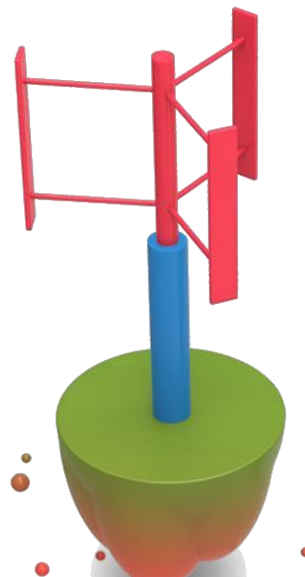
Figura 5 - Aerogerador com rotor H-Darrieus
