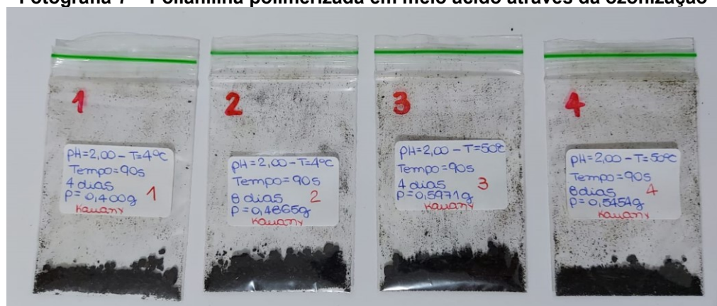
Fotografia 7 – Polianilina polimerizada em meio ácido através da ozonização 1
