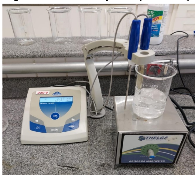
Fotografia 2 – Processo de ajuste do pH nas soluções
