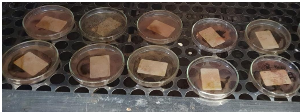
Fotografia 6 – Amostras secas na estufa prontas para serem raspadas da placa e pesadas
