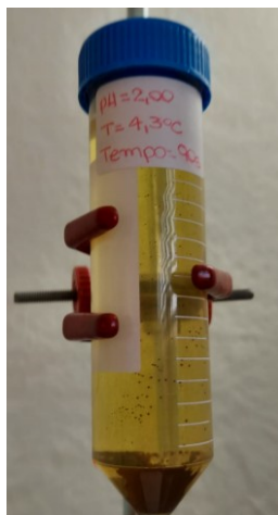
Fotografia 4 – Solução que contém a polianilina após sair da centrifuga
