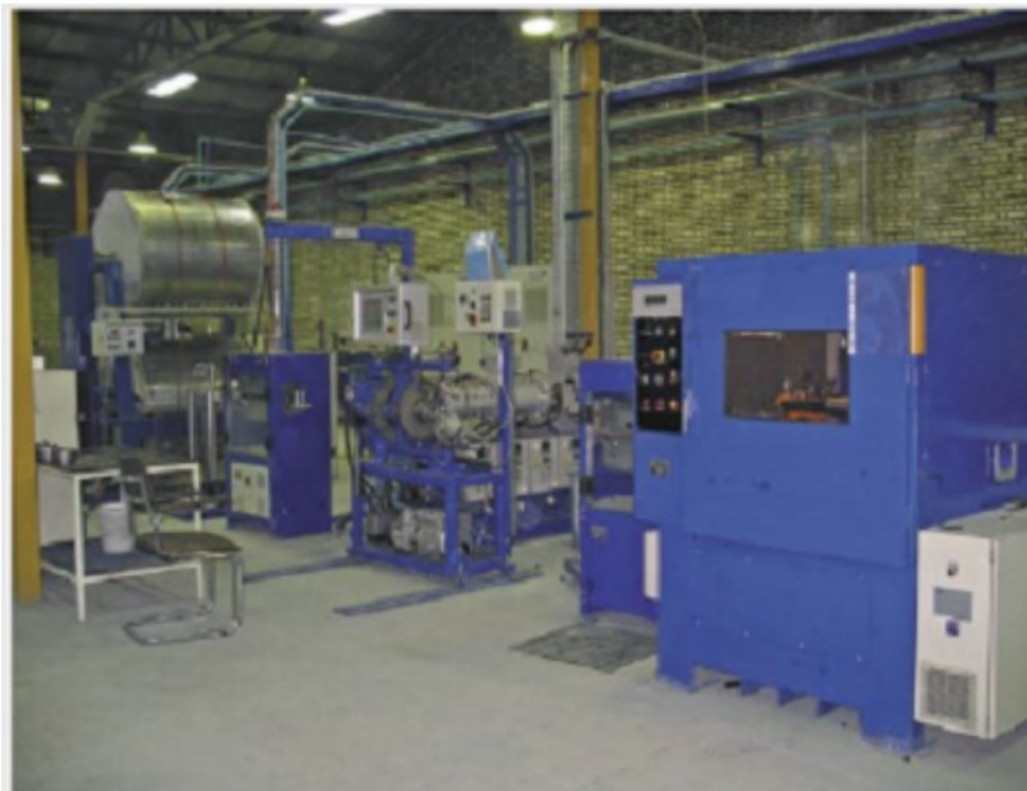
Figura 7 - Linha de produção de mangueiras de arrefecimento
