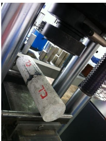
Figura 39 - Teste de resistência à tração Fonte: Autora.
