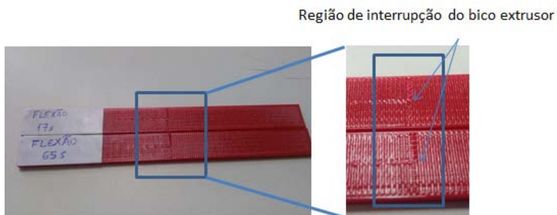
Figura 4.6 - Corpo de prova de flexão com interrupção Fonte: Autoria própria.
