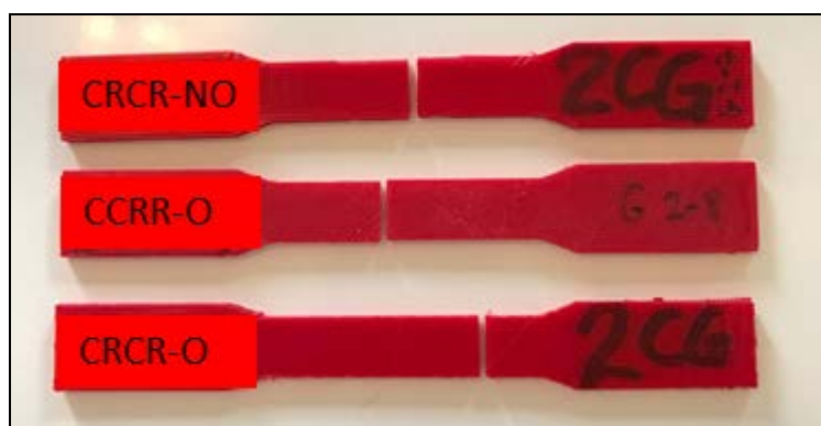
Figura 4.3 - Fotos de alguns corpos de prova de tração fraturadas para os métodos CRCR-NO, CCRR-O e CRCR-O
