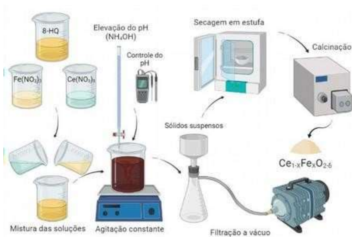
Figura 9. Representação esquemática da síntese dos óxidos mistos de cério e ferro por meio da decomposição térmica de 8-hidroxiquinolinatos. Fonte: Autoria própria (2022). Criado com BioRender.com
