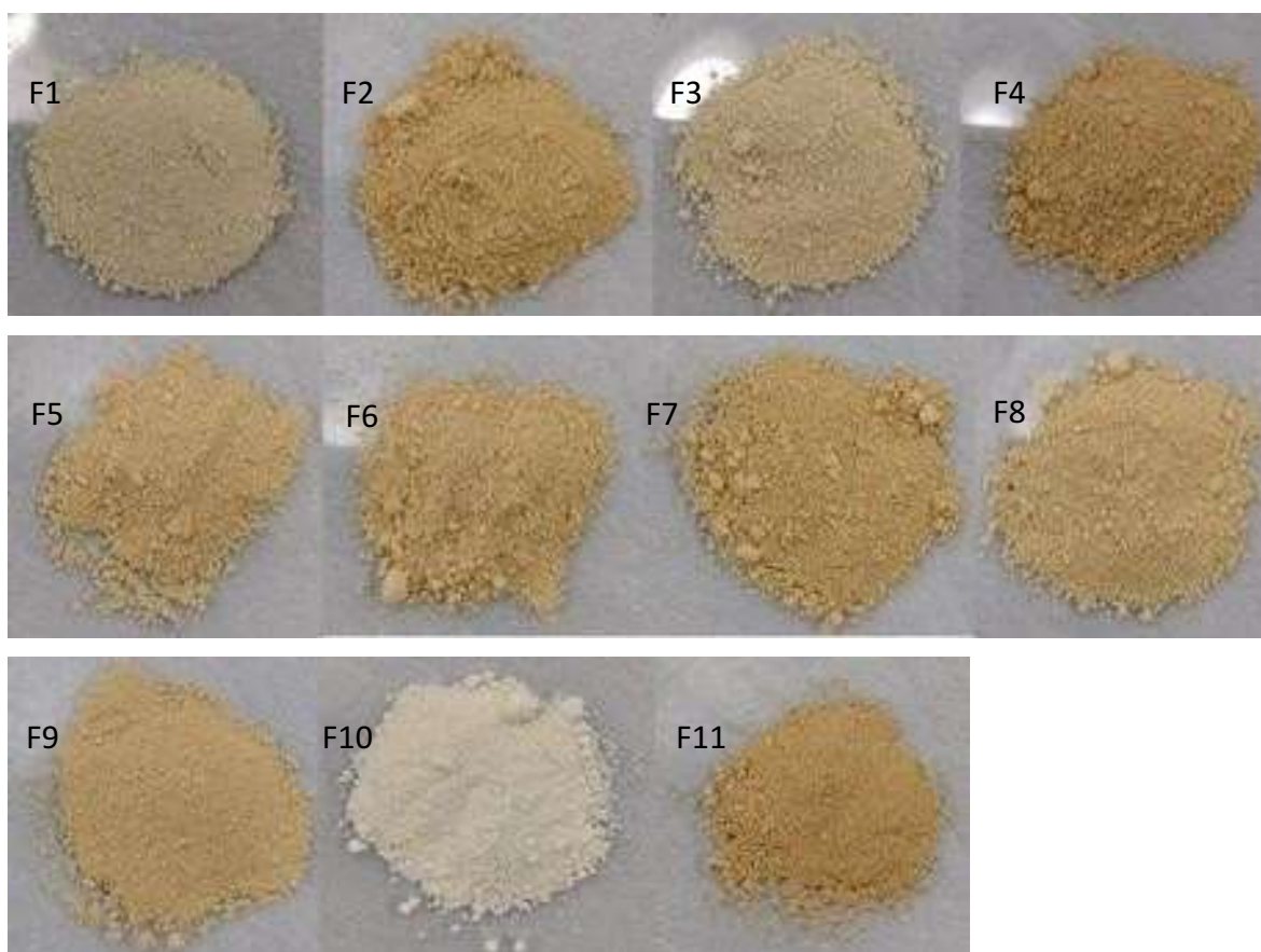
Figura 23 – Aspecto visual dos óxidos mistos de cério e ferro sintetizados por meio da decomposição térmica de 8-hidroxiquinolinatos. Fonte: Autoria própria (2022).
