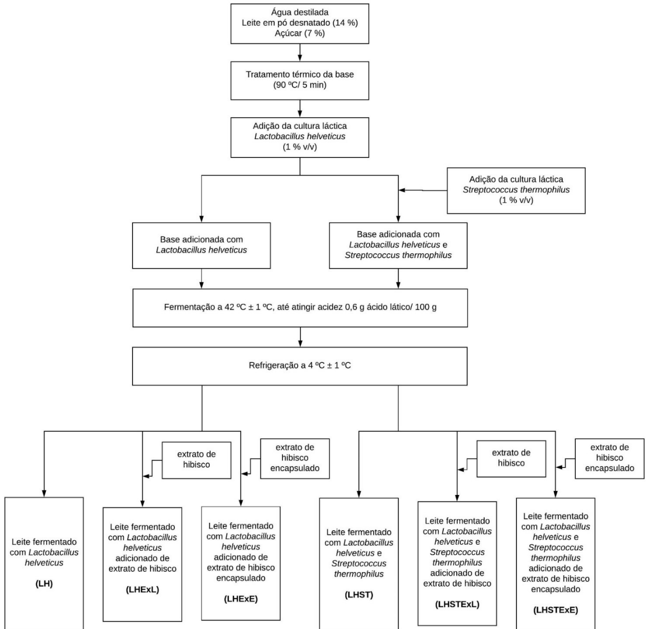
Figura 1 – Fluxograma de fabricação dos leites fermentados.
