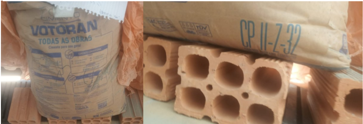
Fotografia 1. Cimento utilizado para dosagem do concreto (CP II-Z-32)
