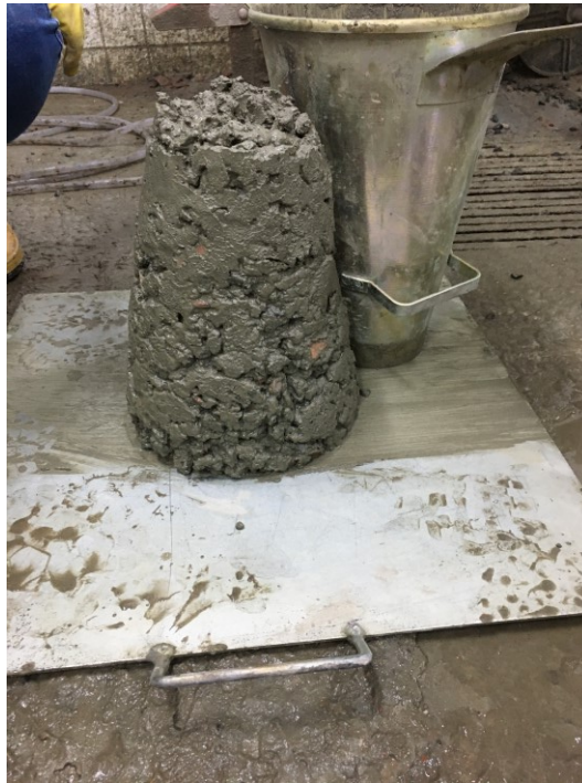
Fotografia 11. Slump teste de concreto firme
