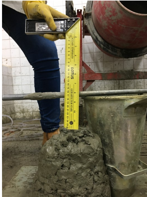
Fotografia 12. Slump Test concreto plástico
