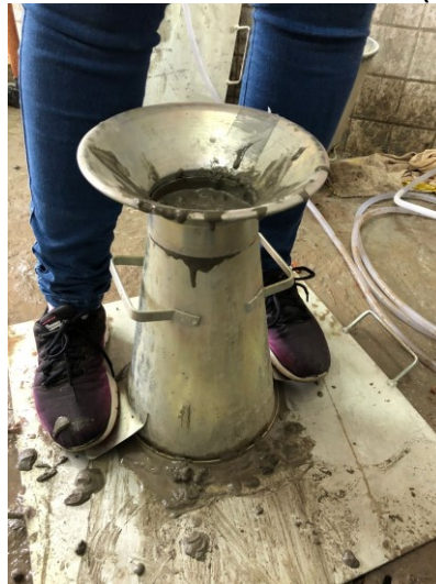
Fotografia 4. Ensaio de consistência do concreto ( Slump Test )
