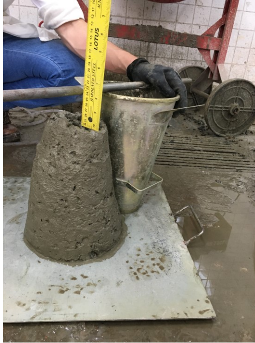
Fotografia 5. Abatimento do concreto - Slump Test
