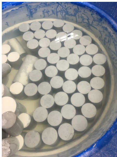
Fotografia 8. Armazenamento dos CP's em tanque com solução de cal hidratada
