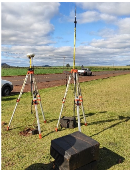
Figura 18 Montagem do sistema GNSS Trimble RTK R4.
