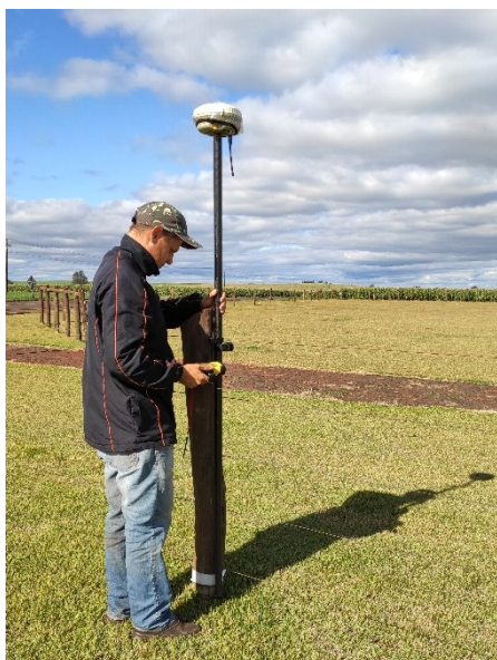
Figura 23 Momento em que o piquete era georreferenciado utilizando-se o equipamento de alta precisão.
