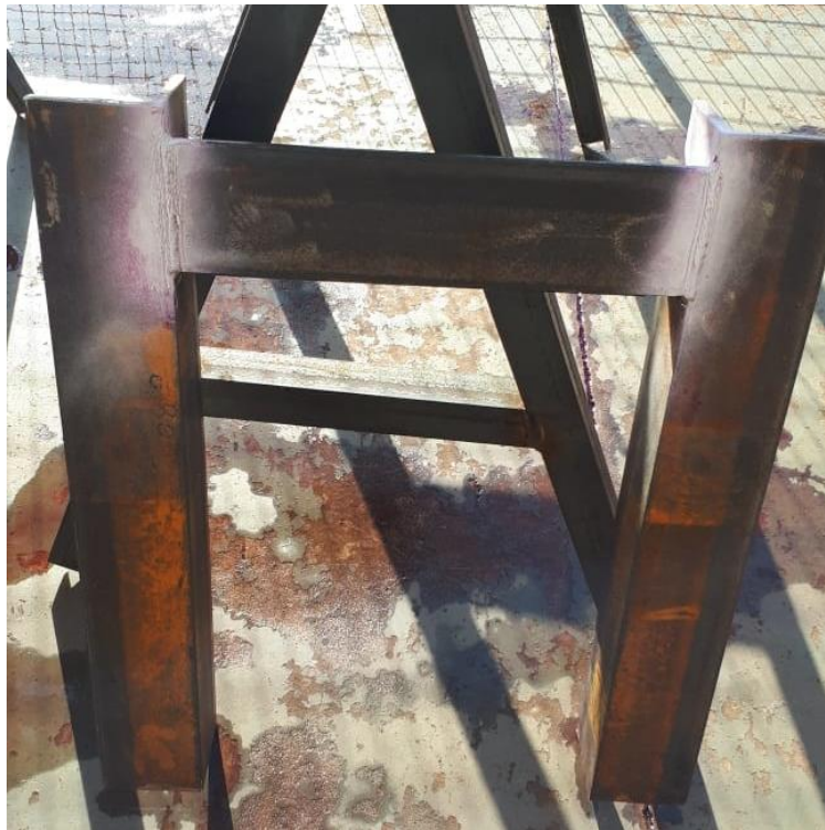
Fotografia 7 – Suporte aprovado pelo ensaio LP
