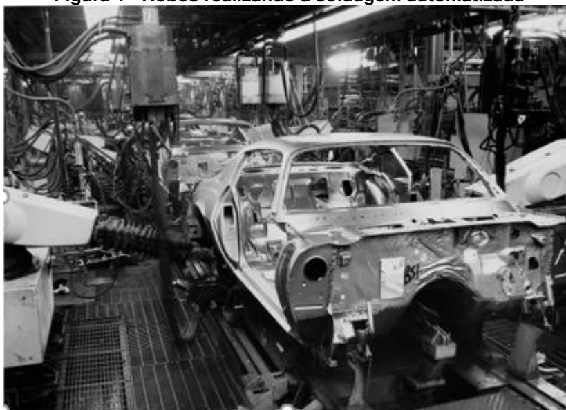
Figura 1 - Robôs realizando a soldagem automatizada
