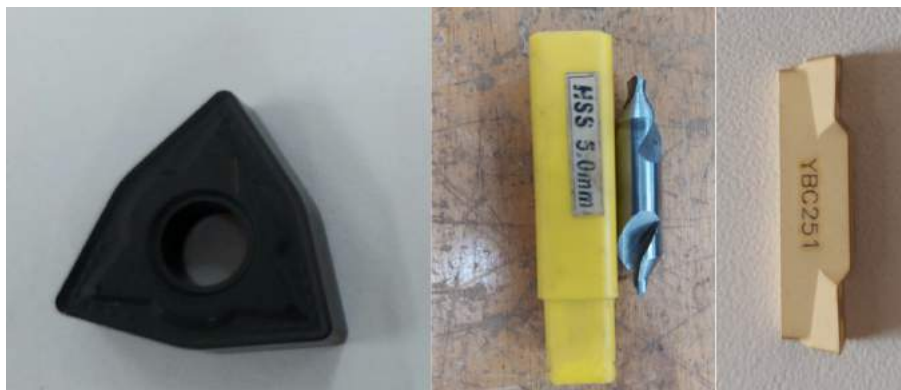
Figura 11 – Pastilha WNMG 080408 NM PL10, broca de aço rápido e pastilha para canal.
