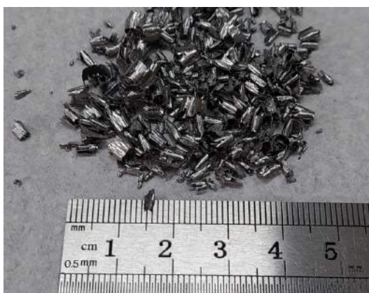
Figura 19 – Cavacos gerados na abertura dos canais no 1045.
