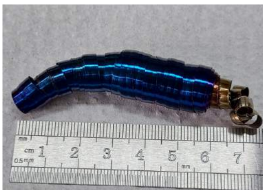
Figura 20 – Cavacos gerados na abertura dos canais no Toolox® 44.
