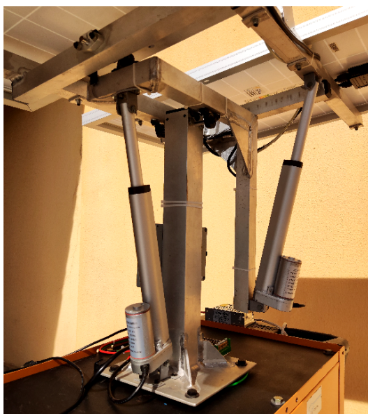
Figura 5 – Fixação dos atuadores na estrutura biaxial
