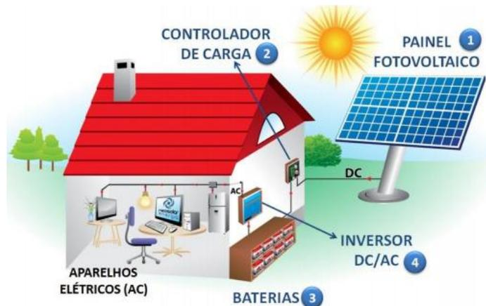
**Figura 17 - Configuração de um sistema Off-Grid.**
