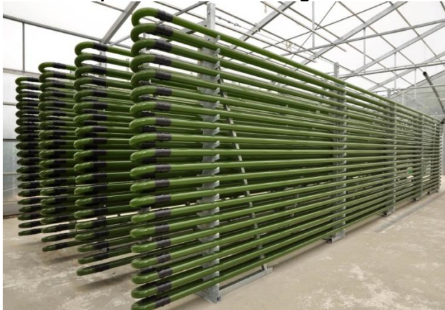
Figura 19 - Fotobiorreator para cultivo de microalgas em sistema fechado.
