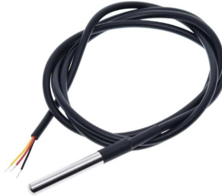
Figura 12- Sensores modelo DS18B20 utilizado para coleta de dados
