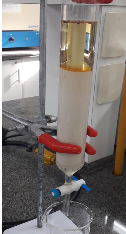
Figura 4 - Coluna com a Resina adsorvente XAD 8
