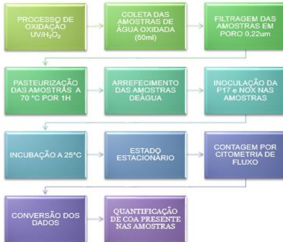
Figura 6 - Fluxograma da sequência do procedimento utilizado para a quantificação de COA.
