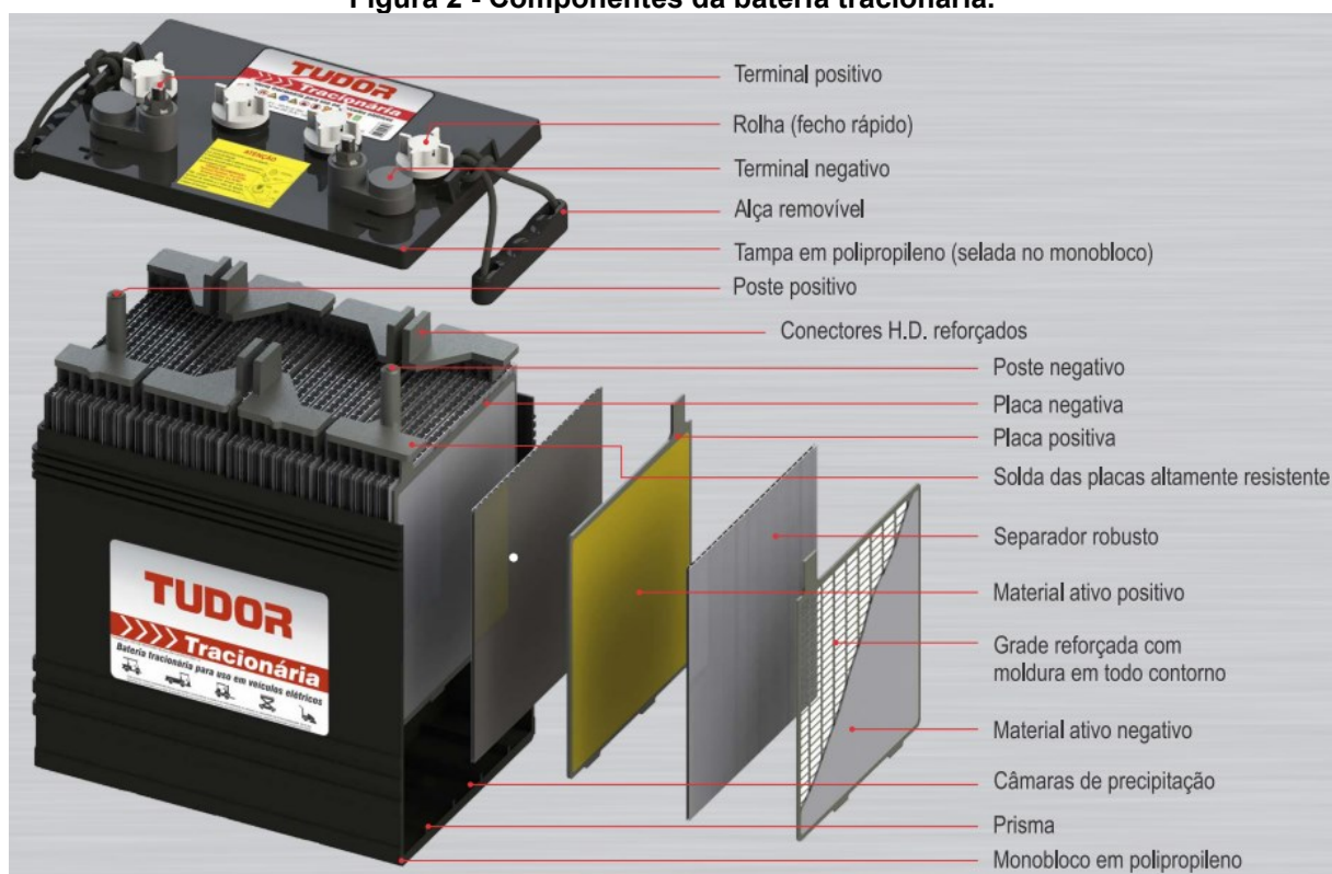
Figura 2 - Componentes da bateria tracionária.
