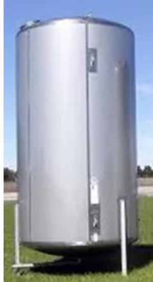
Figura 53 - Tanque de armazenamento de cal hidratada
