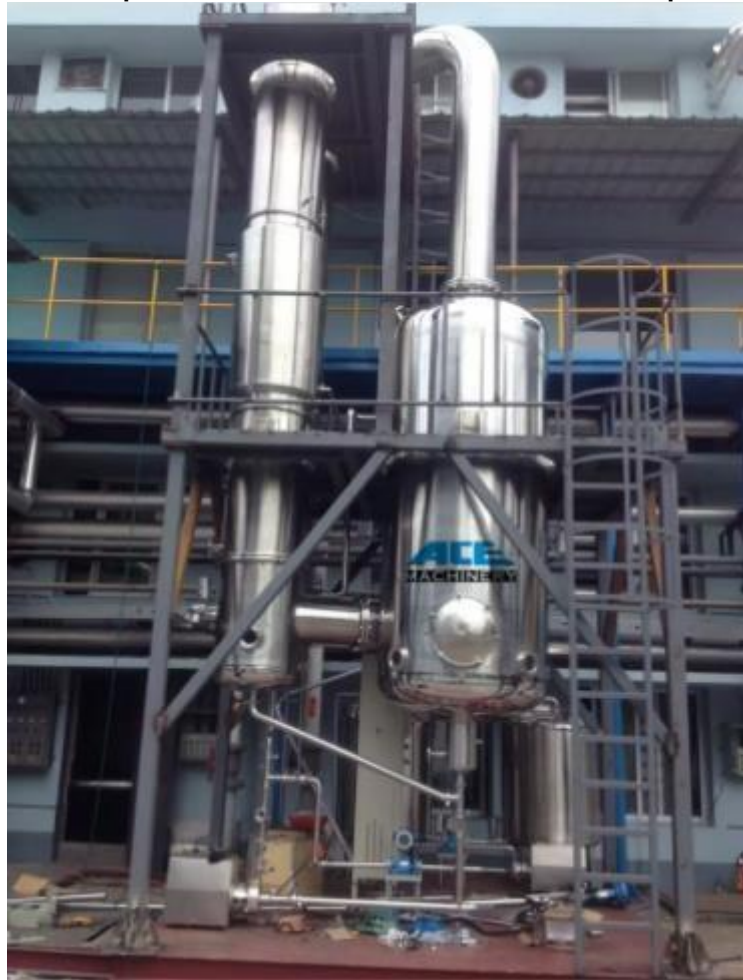
Figura 41- Evaporador de filme descendente de efeito simples
