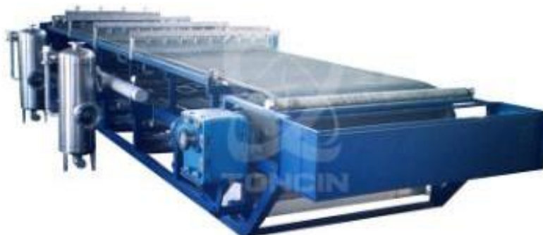
Figura 39- Filtro de banda horizontal a vácuo
