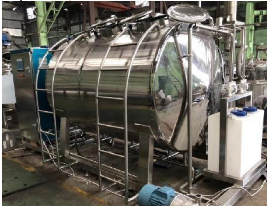
Figura 52 - Tanque de armazenamento de nitrato de amônio
