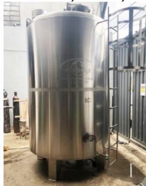
Figura 36 - Reator de fermentação em aço inox AISI 304
