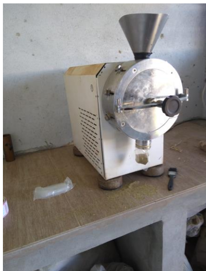
Figura 5. Moinho de facas utilizado.
