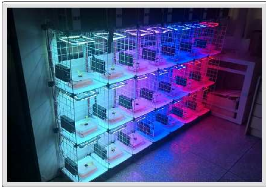
Figura 44 – Experimento de validação simulando a rotina de funcionamento (iluminação/irrigação), com o uso de diferentes espectros de luz combinados ao uso da bandeja hidropônica.
