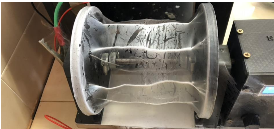
Figura 27 – Filme obtido no processamento do PVA11#1 com 4,55% de produtividade.
