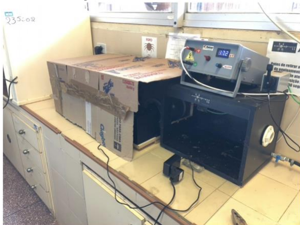
Figura 10 – Da esquerda para a direita, adoção de cobertura externa sobre o processo de eletrofiação e coletor rotativo com as fibras jateadas após a realização de eletrofiação.
