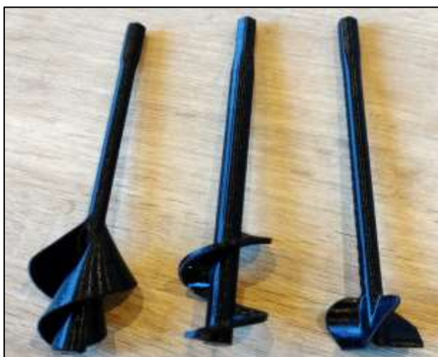
Figura 18: Modelos de pás impressos em PETG.
