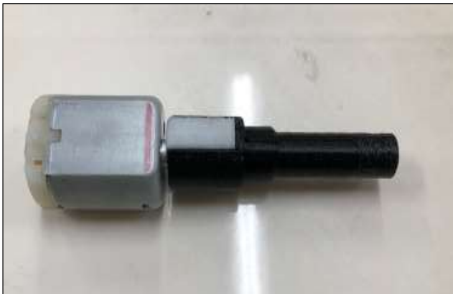
Figura 12: Eixo do motor com faixa para contador de rotação
