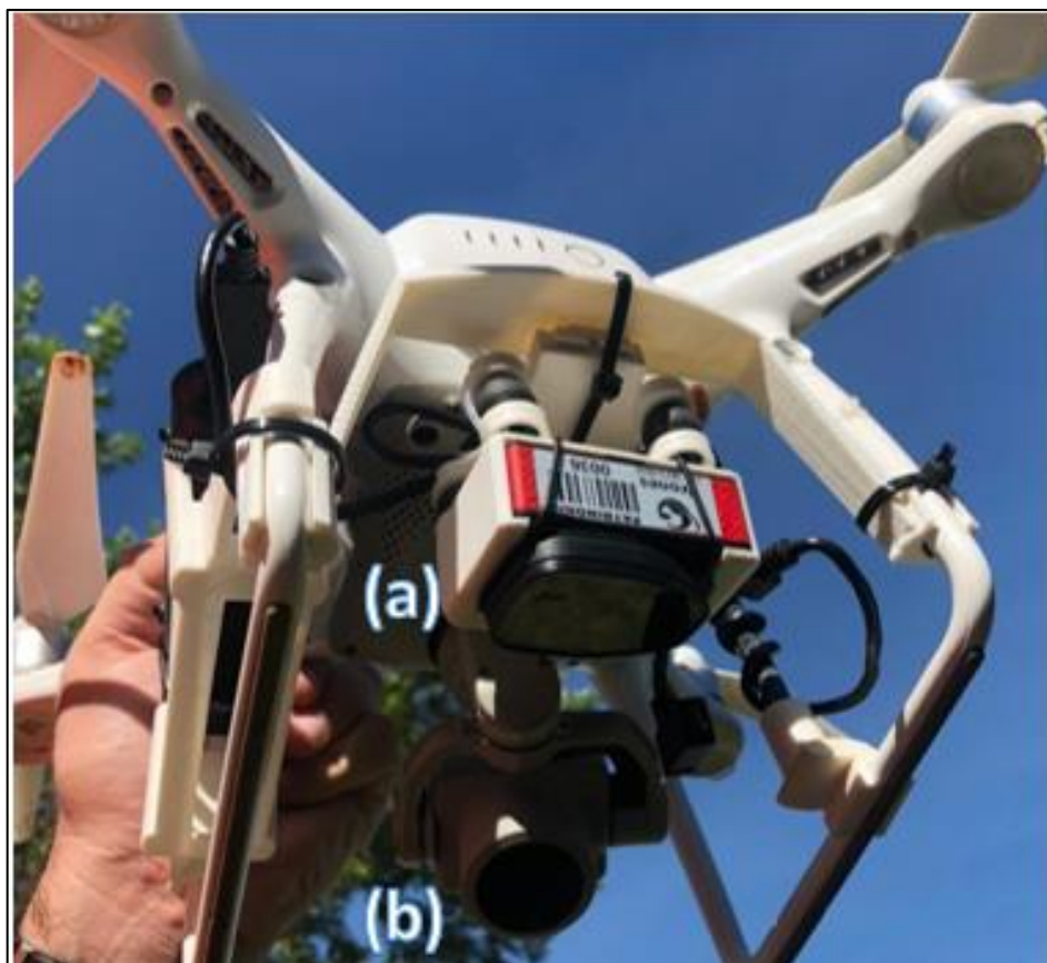
Legenda: (a) Camera Multiespectral Parrot Sequoia ® ; (b) Câmera RGB do VANT Dji Phantom 4 Pro ® . Fonte: Autoria Própria (2021).
