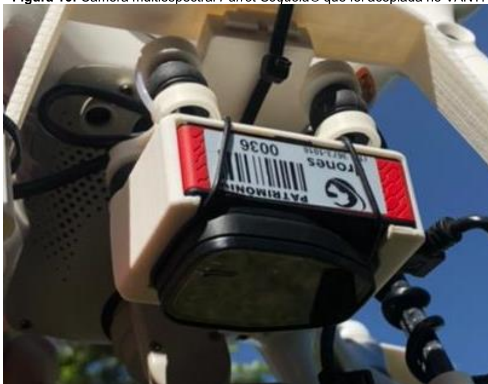
Figura 16: Câmera multiespectral Parrot Sequoia ® que foi acoplada no VANT.
