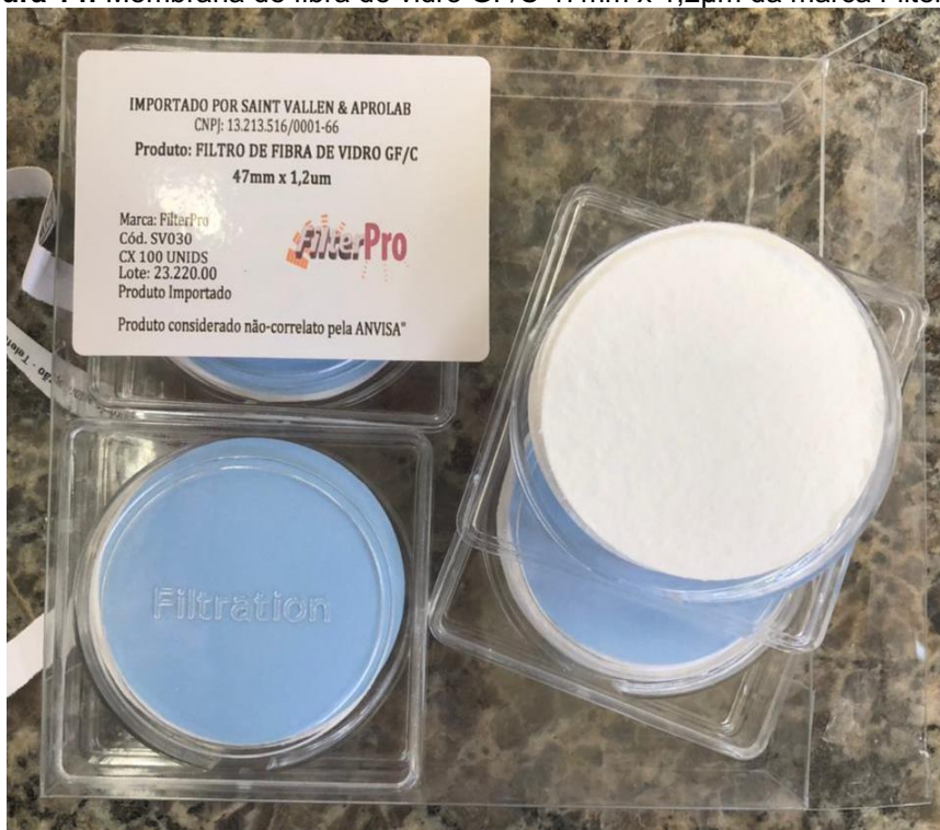
Figura 14: Membrana de fibra de vidro GF/C 47mm x 1,2 \mu\text{m} da marca FilterPro .
