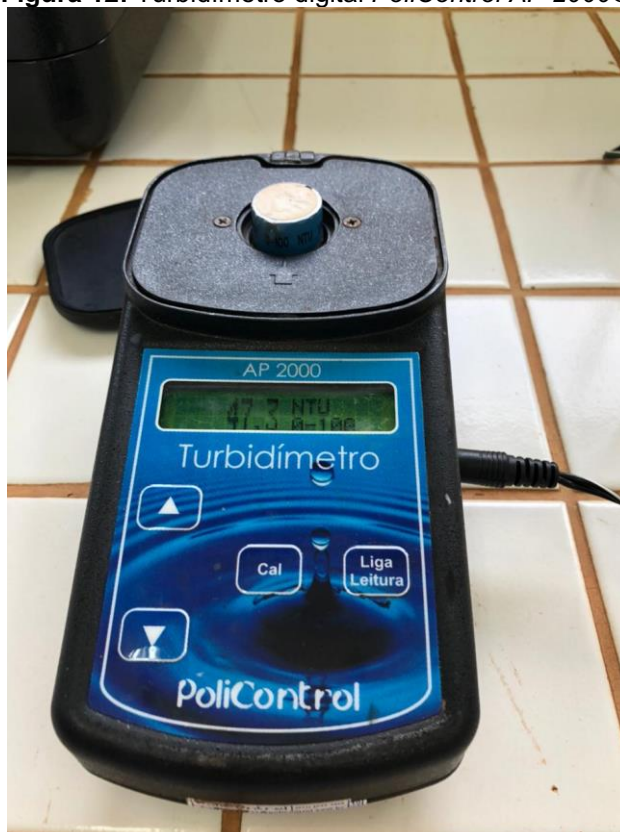
Figura 12: Turbidímetro digital PoliControl AP 2000 ®.
