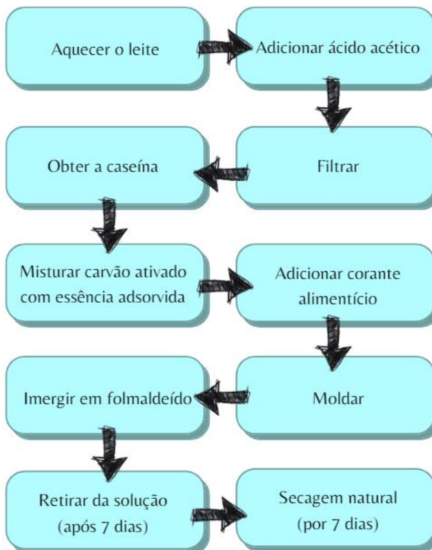
Figura 6 - Fluxograma da produção do acessório
