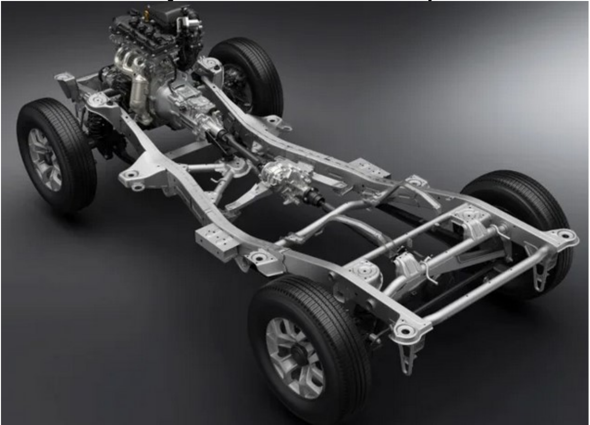
Figura 8 - Chassi escada de um Suzuki Jimny
