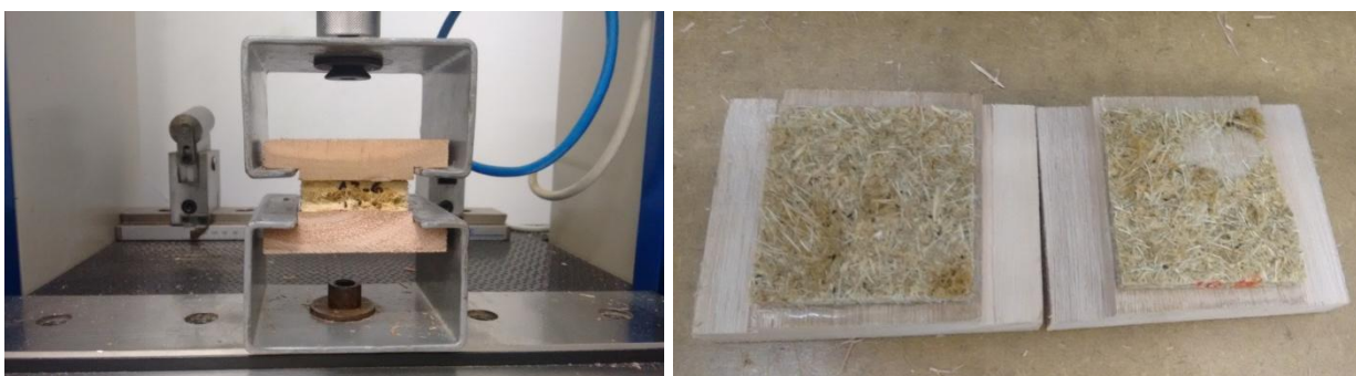
Figura 22 - Realização de ensaio de tração. (a) Corpo de prova em rompimento durante tração; (b) Corpo de prova rompido após ensaio
