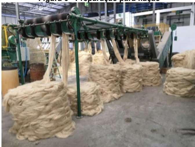
Figura 6 - Preparação para fiação
