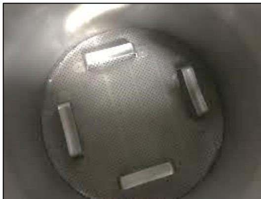
Figura 9 – Fundo da tina de filtração
