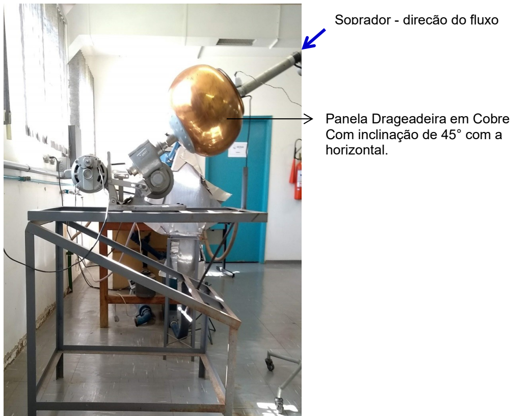
Figura 25 – Arranjo do soprador de ar em relação ao eixo da drageadeira
