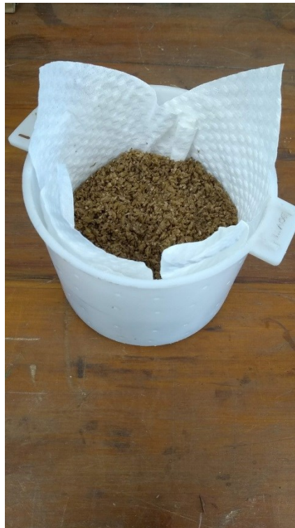
Figura 29 – Feltro utilizado no ensaio de desaguamento em presa hidráulica
