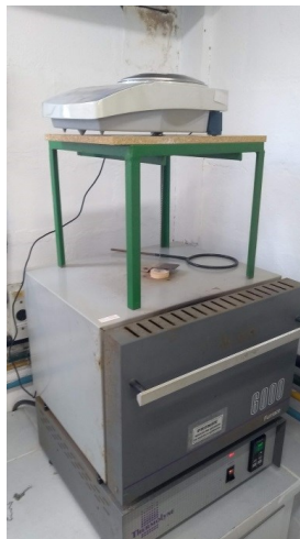
Figura 19 – Arranjo do ensaio em estufa sem recirculação DEQ/UFSCar
