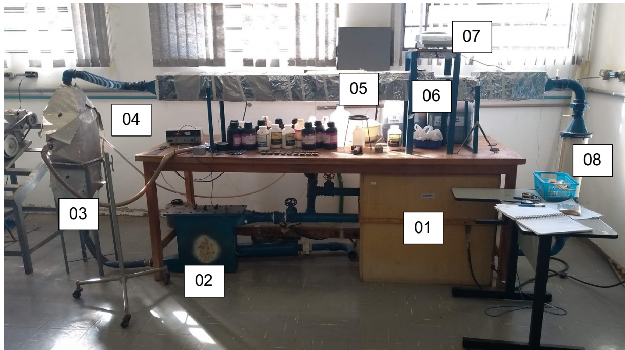
Figura 20 – Túnel de vento
