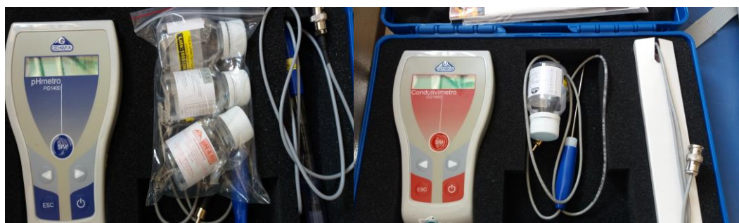
Figura 3 – pHmetro (esquerda) e condutímetro digital (direita) utilizados para analisar o pH e condutividade elétrica da solução. Fonte: O autor (2019).
