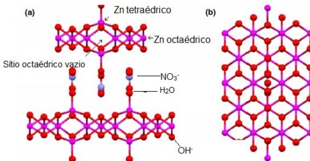
Figura 4 - Esquema de um hidroxissal lamelar: (a) Visão Lateral; (b) Visão superior da lamela.
