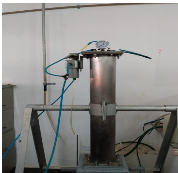
Figura 6 - Representação do módulo experimental da flotação por ar dissolvido
