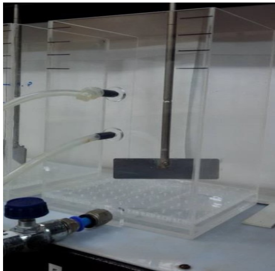
Figura 7 - Modelo de jarro adaptado ao sistema da flotação por ar dissolvido
