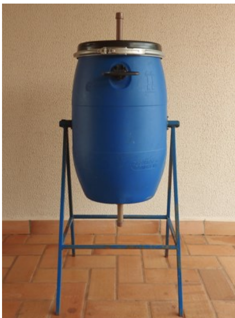
Figura 6 Composteira giratória com capacidade de 60 L.
