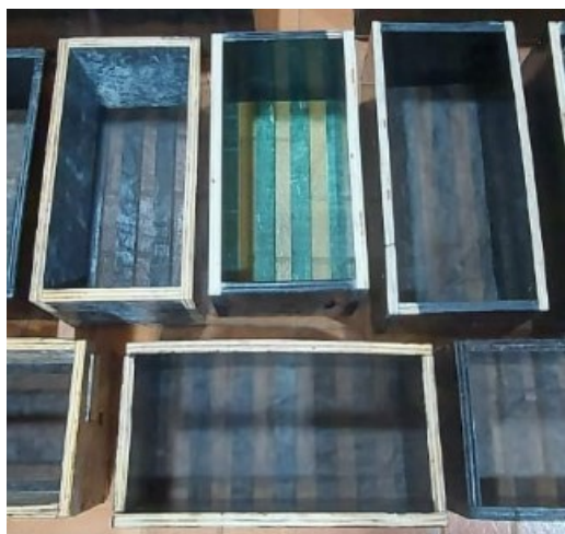
Figura 7 Vermireatores de madeira, com fundo vazado (a) e cobertos com tela de polietileno (b).
