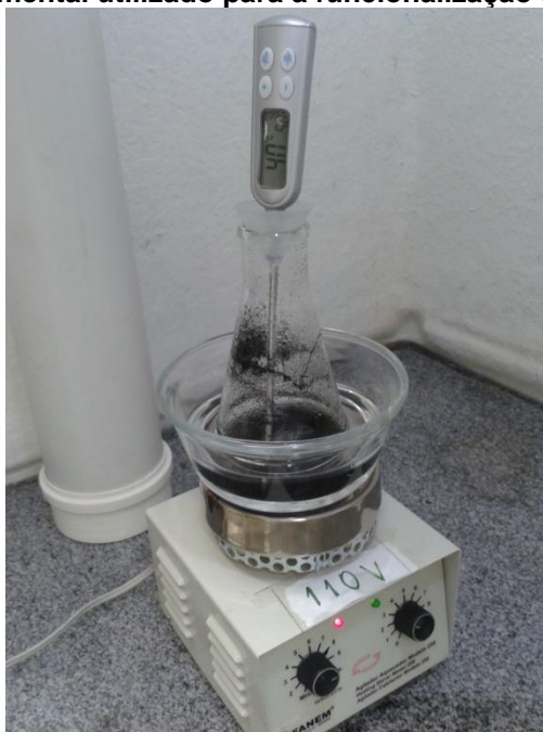
Figura 10 – Aparato experimental utilizado para a funcionalização dos adsorventes com \text{HNO}_3
