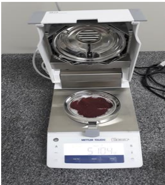
Fotografia 4 – Analisador de umidade Metter Toledo
