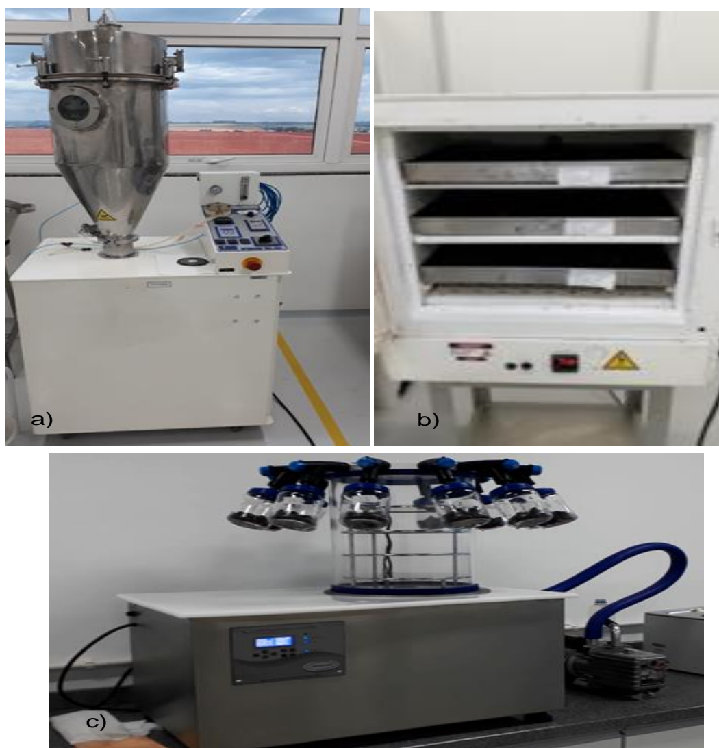
Fotografia 2- Equipamentos utilizados para secagem do material vegetal. (a) Leito Fluidizado (b) Estufa com circulação forçada de ar (c) liofilizador
