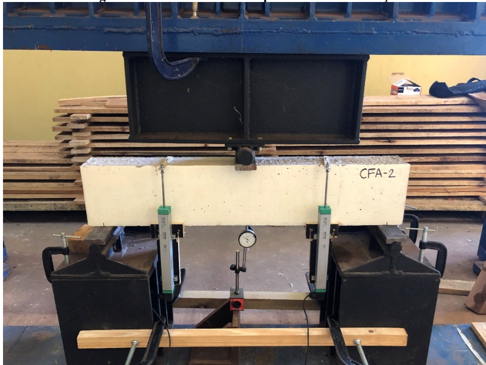
Figura 9 - Ensaio de flexão a 3 pontos e instrumentação.
