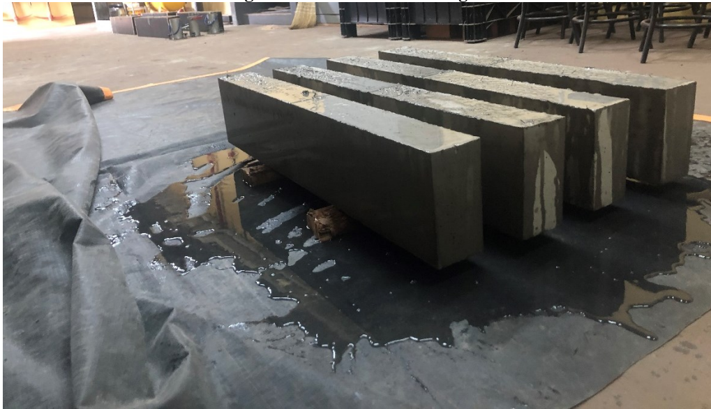
Figura 6 - Cura úmida das vigas.
