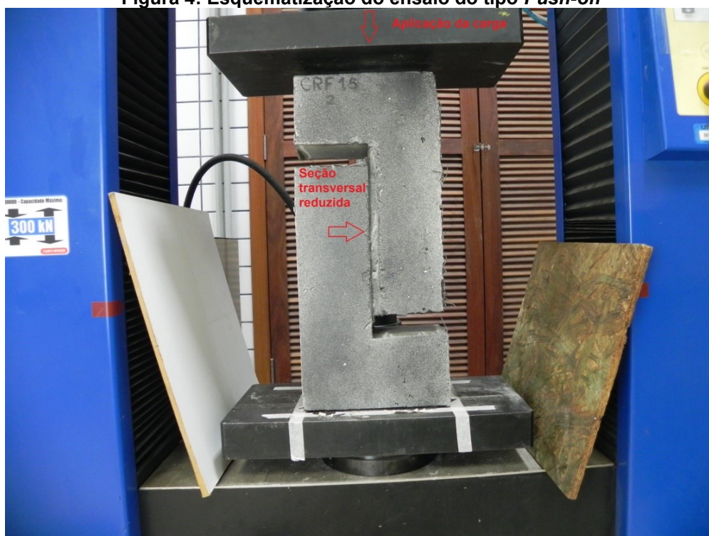
Figura 4: Esquemática do ensaio do tipo Push-off
