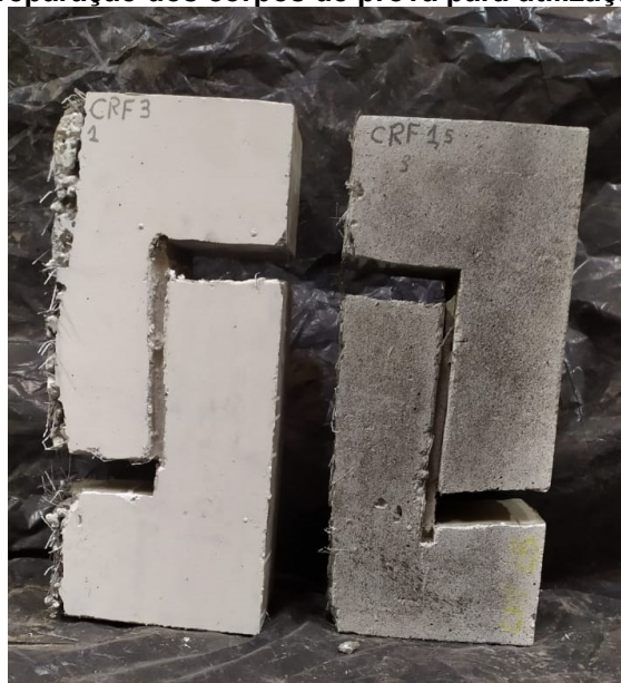
Figura 16: Processo de preparação dos corpos de prova para utilização do método CID
