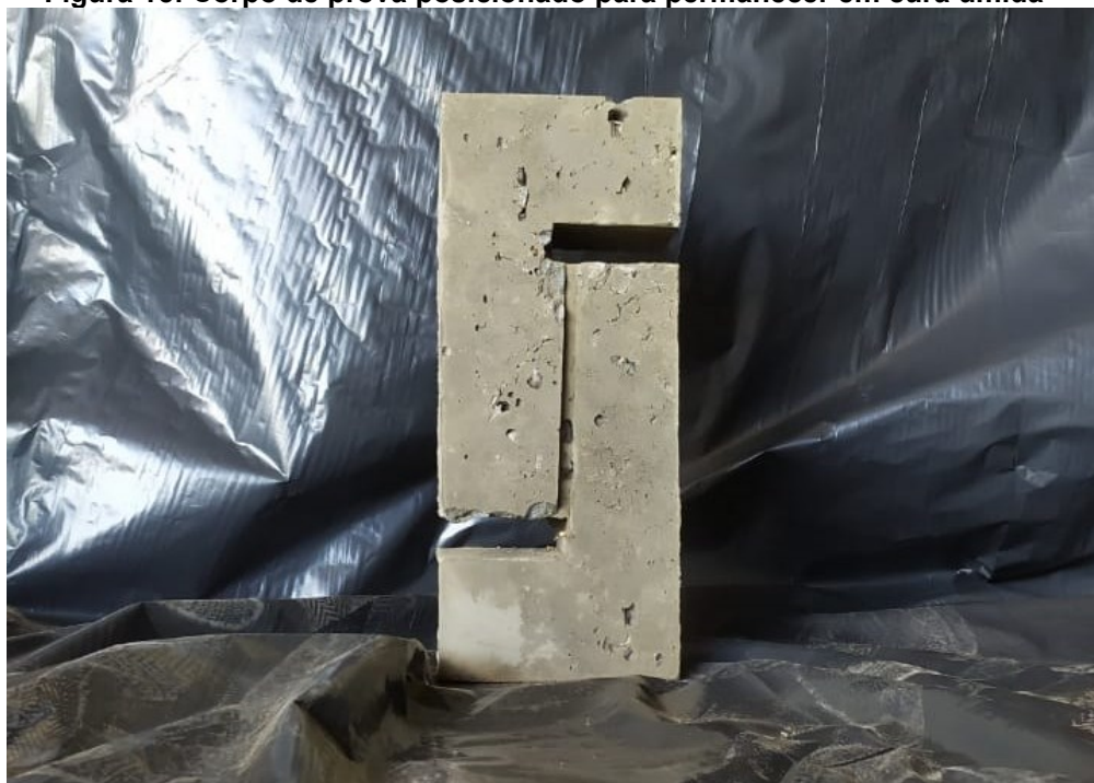
Figura 15: Corpo de prova posicionado para permanecer em cura úmida
