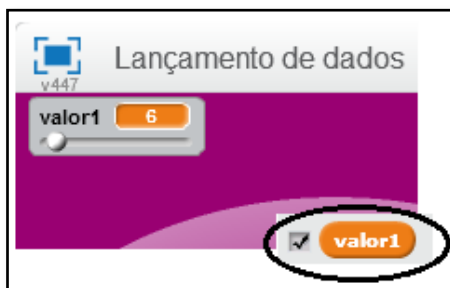
Figura 81 – Monitor da variável como controle deslizante
