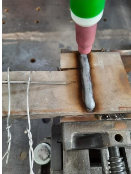
Figura 11 - Ilustração do cordão de solda.
