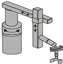
Figura 4 - Manipulador cilíndrico (a) Vista do manipulador (b) Área de trabalho do manipulador
