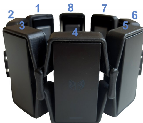
Figura 5 - Armband comercial Myo™ usada para realizar a aquisição, com destaque aos seus oito canais.
