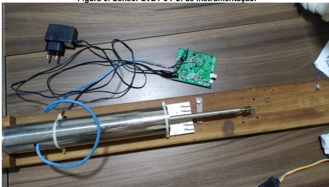
Figura 6: Sensor LVDT e PCI de instrumentação.
