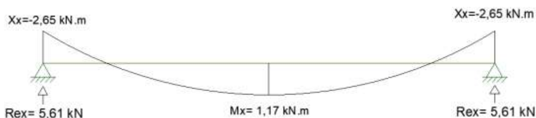
Figura 28: Diagrama Momento Fletor Laje L109 - Eixo x. Fonte: Autoria Própria (2022).
