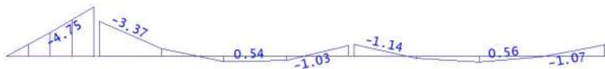
Figura 88: Diagrama de momento fletor (tf.m) V120 - TQS. Fonte: Autoria Própria (2022).
