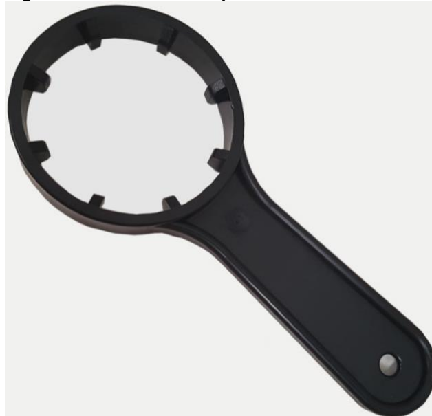
Figura 9 – Chave de Tampa Utilizada no Processo
