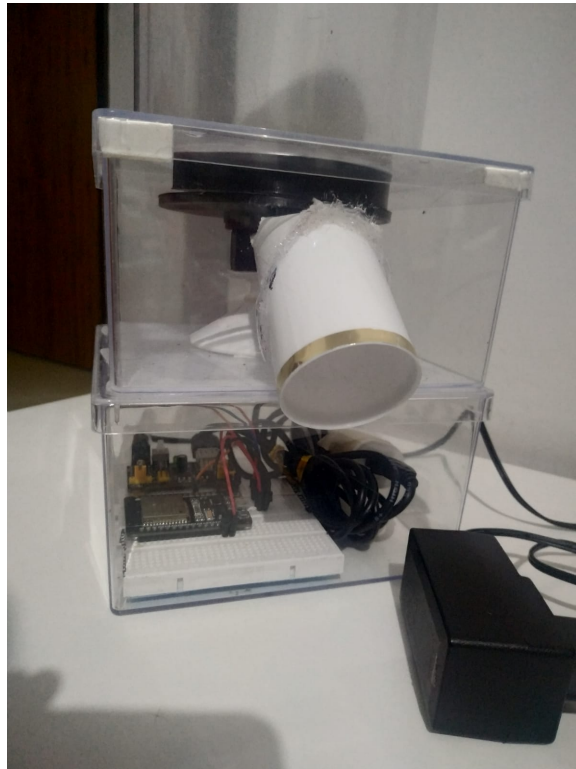
Figura 31 – Alimentador automático BiBiCat vista dos componentes Fonte: Autoria própria (2022).
