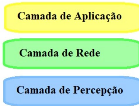
Figura 6 – Arquitetura básica de IoT em três camadas Fonte: Autoria Própria.
