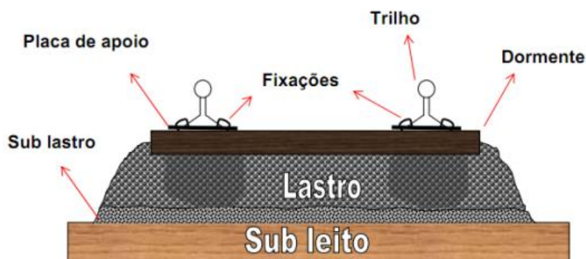
Figura 1 - Seção transversal da plataforma ferroviária
