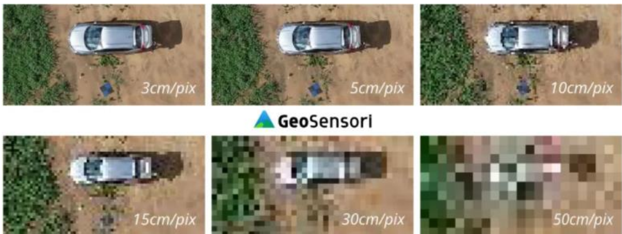
Figura 10 - Correlação entre resolução da imagem e GSD
