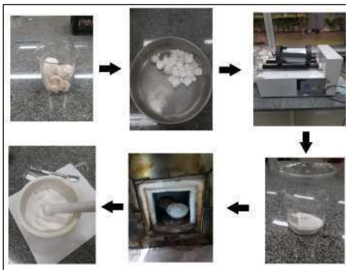
Figura 4.9 – Etapas da obtenção do catalisador CaO
