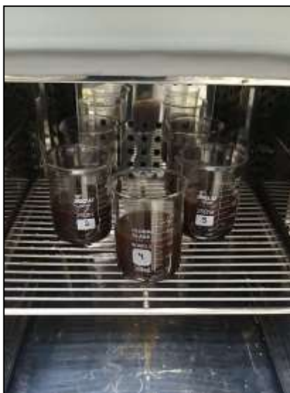
Figura 4.3 – Secagem em estufa das suspensões de borra de café após a pré-extração por plasma
