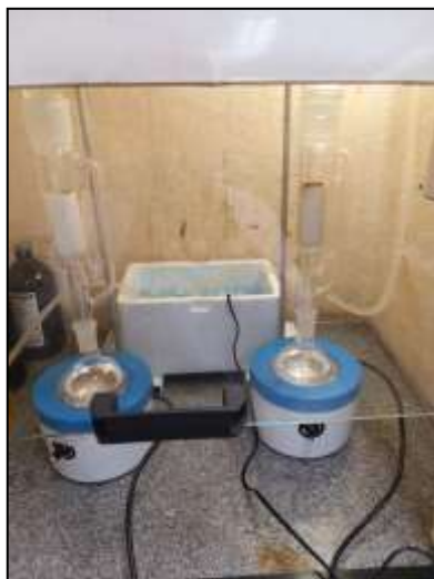
Figura 4.4 – Sistema de extração Soxhlet juntamente com o sistema de refluxo de água
