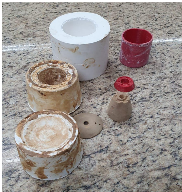
Figura 11 - Molde de gesso com os modelos impressos em 3D e corpos de prova confeccionados em argila
